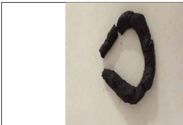
**Рис.6.** Определение механического состава полевым методом
